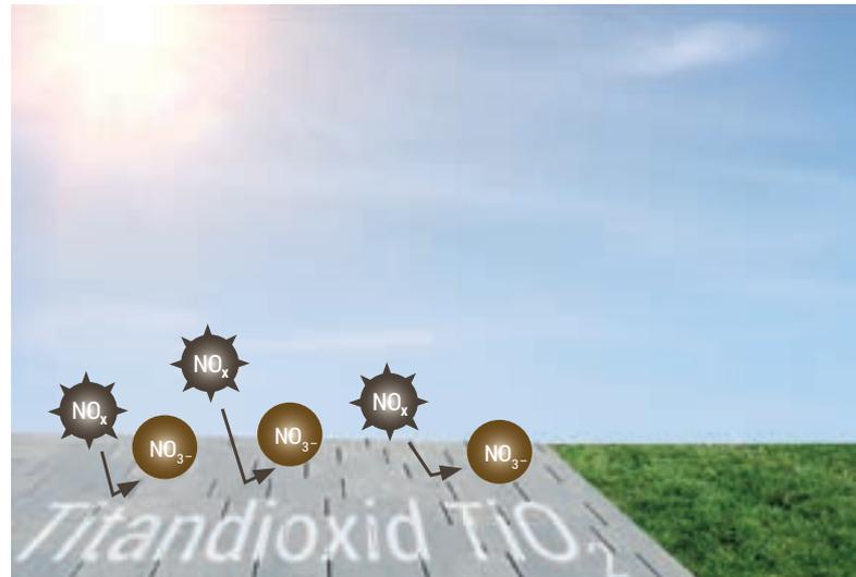
Mithilfe von Sonnenlicht wandelt Titandioxid (TiO<sub>2</sub>) Stickoxide (NO<sub>x</sub>) in Nitrat (NO<sub>3</sub><sup>-</sup>) um.
