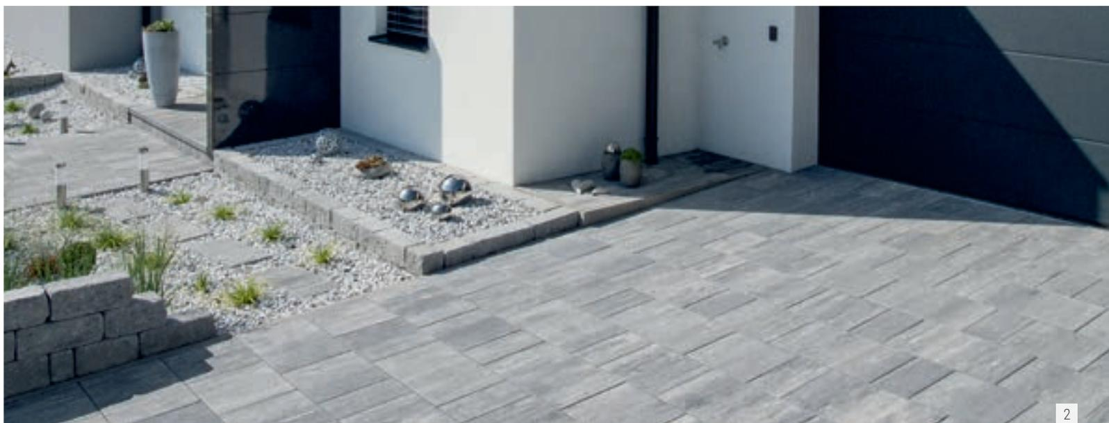
Wer dominante Formate bevorzugt und gleichzeitig eine spannende Struktur auf der gepflasterten Fläche haben möchte, findet diese Anforderungen im CAMPUS VG4 Pflaster bestens erfüllt. Die unterschiedlichen Längen der Steine sorgen für Auflockerung, weshalb sich das Pflaster auch für große Befestigungen eignet.
