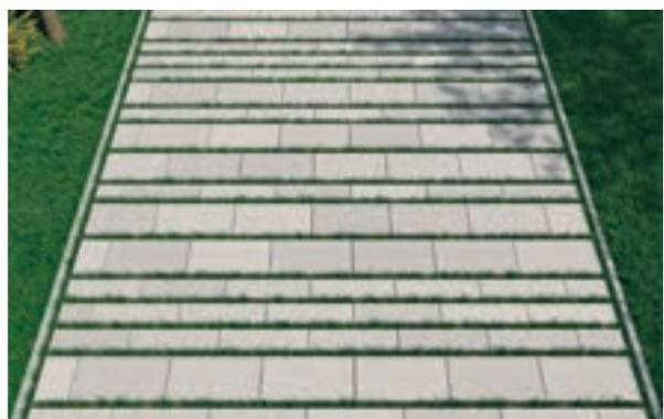
LINEA VG4 Pflasterplatte 60 x 15 x 8 cm und 60 x 30 x 8 cm in unregelmäßige Bahnen mit 55 mm breiten horizontalen Fugen verlegt.
