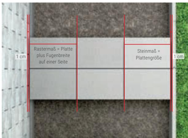
**Berücksichtigen Sie bei der Berechnung der Pflasterfläche mithilfe des Rastermaßes an den Anschlüssen je 1 cm Randfuge**
