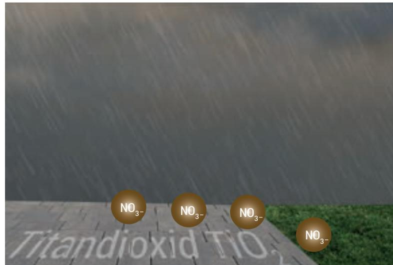
Regenwasser transportiert das Nitrat (NO<sub>3</sub><sup>-</sup>) von der Fläche. Es wird nicht mehr Nitrat freigesetzt als durch den natürlichen Abbau von NO<sub>x</sub>. Das Nitrat dient den Pflanzen als Nährstoff.
