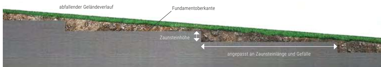
Abbildung 8: Abgestuftes Fundament bei einem Gefälle
