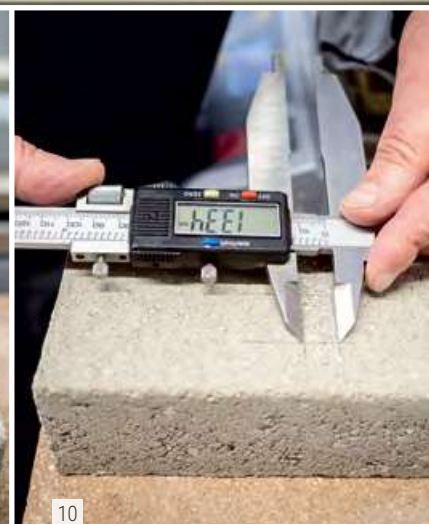
8 + 9 + 10 Bestimmung des Abriebwiderstands. Die Oberseite des Steins wird mit einem Schleifmittel unter genormten Bedingungen abgeschliffen. Die Abriebstelle angezeichnet und an drei Stellen gemessen.
