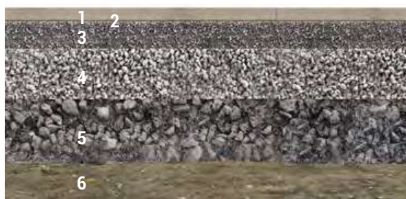
Abbildung 4: Aufbau gebundene Bauweise (Oberbau 1–5)
